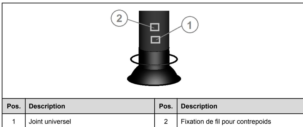
La hotte aspirante peut basculer dans deux directions. Pour ce faire, la hotte aspirante est fixée à l'intérieur du tuyau à l'aide d'un joint universel (1). Si la hotte aspirante ne se manœuvre plus que difficilement, ou si elle ne reste plus à la position réglée, un réajustage est nécessaire.
